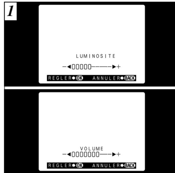
Lorsque vous utilisez les réglages "LUMINOSITE LCD" ou "VOLUME", une barre de réglage apparaît sur le moniteur LCD.
