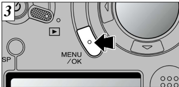
Pour annuler le réglage d'impression, affichez l'image pour laquelle le réglage doit être annulé et appuyez ensuite sur la touche "MENU/OK". Lorsque le réglage d'impression a été annulé, l'image suivante apparaît avec le message "[RAZ OK?]" affiché.
