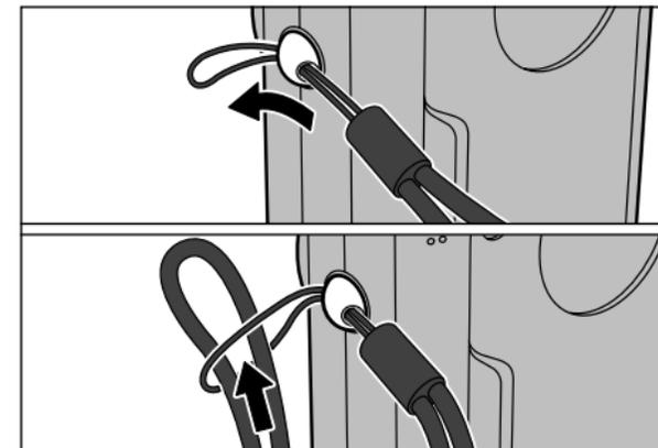
Passez la boucle du cordon fin à l'extrémité de la dragonne dans la monture de dragonne. Passez ensuite l'autre extrémité de la dragonne dans la boucle du cordon fin et serrez la dragonne en tirant.
