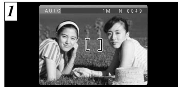
Dans une photo avec ce genre de composition, les sujets (deux personnes dans ce cas) ne sont pas dans le cadre AF. Si la photo est prise à ce moment-là, les sujets ne seront pas mis au point.
