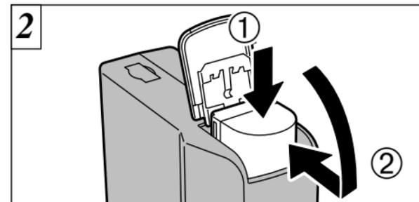
1 Maintenez l'accumulateur, 2 et fermez le couvercle du logement de l'accumulateur.
