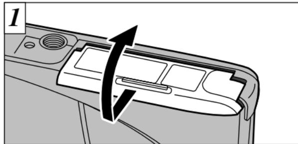
Faites glisser le couvercle du logement des batteries dans la direction indiquée par la flèche et ouvrez le couvercle.
