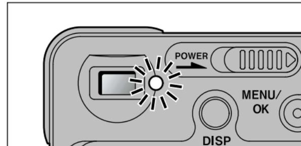
Lorsque le témoin du viseur est orange ou qu'il clignote en vert, l'accès aux données (téléchargement) est en cours. N'ouvrez jamais le volet du logement et ne débranchez pas le câble pendant l'accès aux données. Ceci peut empêcher le téléchargement des données et provoquer des défauts de fonctionnement de l'appareil photo.
