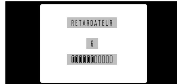
La durée restante jusqu'au moment de la prise de vues est comptée à rebours sur le moniteur LCD.
