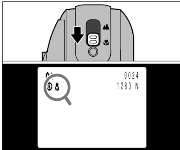
Lorsque vous réglez le sélecteur Normal/Macro sur l'icône "🌸", "🌸" apparaît sur le moniteur LCD et l'appareil photo passe en photographie Macro. Réglez le sélecteur Normal/Macro sur l'icône "▲" pour la photographie normale.
