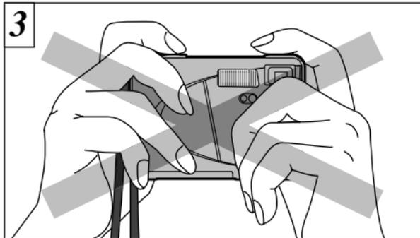
Veillez à ce que ni vos doigts ni la dragonne de l'appareil photo ne gênent l'objectif, le flash ou le capteur de commande du flash.
