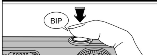
2 Composez la photo de façon à ce que le sujet soit approximativement au centre du viseur ou du moniteur LCD. Appuyez ensuite sur le déclencheur pour régler l'exposition correcte du sujet et faites démarrer le retardateur.
