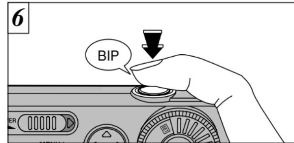
Pour prendre la photo, appuyez à fond sur le déclencheur sans retirer votre doigt. L'appareil photo émet un bip et prend la photo. Les données sont alors enregistrées.
