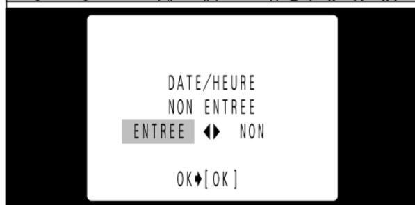
Déplacez l'interrupteur "POWER" en direction de la flèche pour mettre l'appareil photo sous ou hors tension. Le témoin du viseur est vert lorsque l'appareil est mis sous tension. Si vous n'avez pas réglé la date, un écran de confirmation apparaît. Appuyez sur "◀" ou "▶" pour sélectionner l'option désirée et appuyez ensuite sur la touche "MENU/OK".
