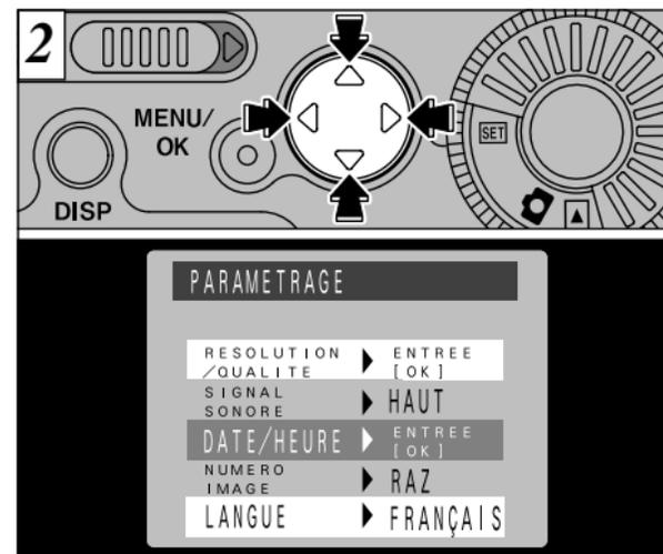
Utilisez la touche "▲▼" pour sélectionner la rubrique désirée et utilisez ensuite les touches "◀▶" pour modifier et confirmer le réglage (n'inclut ni le réglage de la date et de l'heure ni le réglage de taille de fichier/qualité). Pour sortir du menu "PARAMETRAGE", réglez la molette de modes sur "📷" ou "▶".
