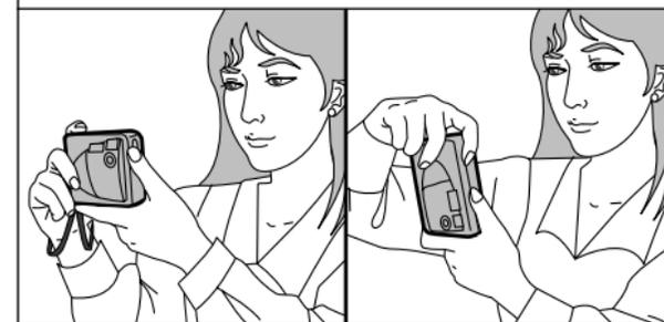
Enroulez la dragonne autour de votre poignet, gardez les coudes contre le corps et saisissez fermement l’appareil photo des deux mains. Lorsque vous tenez l’appareil photo par le côté, maintenez-le de façon à ce que le déclencheur soit sur le dessus.
