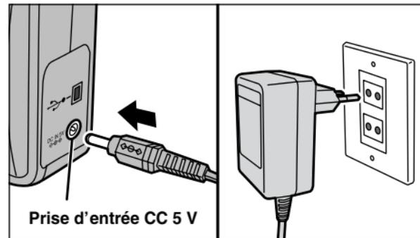
Lorsque vous désirez prendre des photos ou regarder des images sans vous inquiéter d'un éventuel épuisement des accumulateurs, utilisez l'adaptateur secteur spécial AC-5V/AC-5VH. Vérifiez si l'appareil photo est hors tension et branchez le connecteur de l'adaptateur secteur dans la prise d'entrée "DC IN 5 V" de l'appareil. Branchez ensuite l'adaptateur secteur dans une prise de courant.
