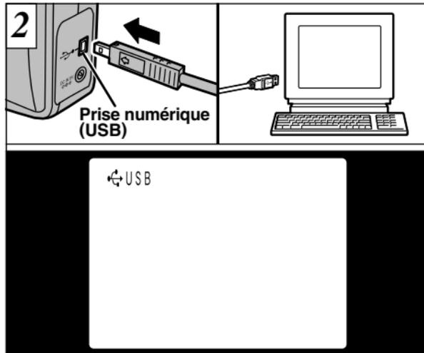
Introduisez la petite fiche du câble de connexion spécial dans la prise DIGITAL (USB) de l'appareil photo et branchez l'autre extrémité du câble dans la prise USB de votre ordinateur personnel. Lorsque vous mettez l'ordinateur sous tension, "🔌 USB" apparaît dans le coin en haut à gauche du moniteur LCD.
