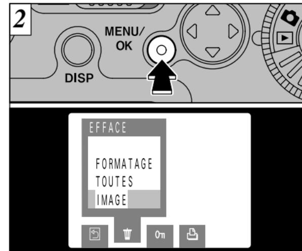
① Utilisez “◀” ou “▶” pour sélectionner “FRAME” (Vue) dans le menu “ERASE” (Effacer).
