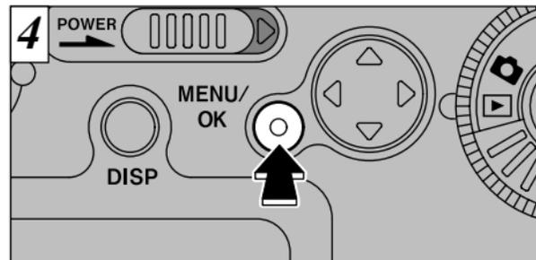
Appuyez sur la touche “MENU/OK” pour effacer l'image affichée. Lorsque l'opération est terminée, l'image suivante apparaît et le message “EFFACER L' IMAGE OK?” apparaît. Appuyez sur la touche “▼” pour annuler l'effacement et revenir au menu.
