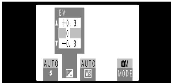
Vous pouvez régler la luminosité lorsque le mode Photographie est réglé sur "M". Utilisez le réglage de luminosité pour obtenir une luminosité optimale de l'image lorsque le sujet est beaucoup plus clair ou plus sombre que le fond.
