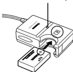
**2** Insérez complètement la batterie dans le chargeur, comme le montre l'illustration.
