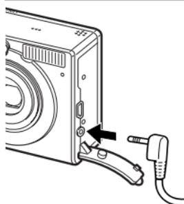
**2 Connectez le câble AV à la borne A/V Out de l'appareil photo.**
