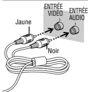
**3 Branchez les autres extrémités du câble AV dans les bornes d'entrée vidéo et audio du téléviseur.**
