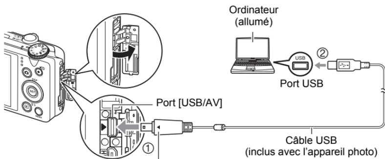
Tout en veillant à bien aligner le repère ► sur l'appareil photo et le repère ◀ sur le connecteur du câble USB, branchez le câble sur l'appareil photo.
