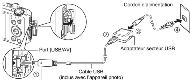
Tout en veillant à bien aligner le repère ► sur l'appareil photo et le repère ◀ sur le connecteur du câble USB, branchez le câble sur l'appareil photo.
