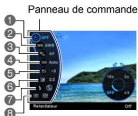
\* Les éléments affichés sur le panneau de commande dépendent du mode d'enregistrement sélectionné.
