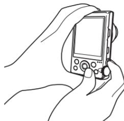
**8. Dirigez l'appareil photo vers le sujet en le centrant bien sur l'image, puis appuyez à mi-course sur le déclencheur pour faire la mise au point.**
