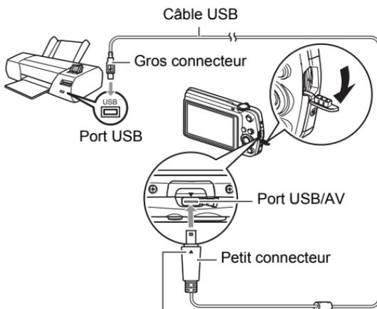
Tout en veillant à bien aligner le repère ▼ sur l'appareil photo et le repère ▲ sur le connecteur du câble USB, branchez le câble sur l'appareil photo.
