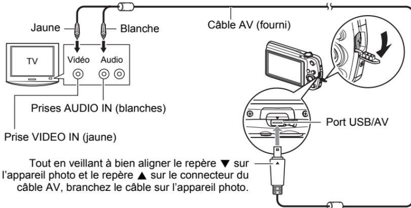
Tout en veillant à bien aligner le repère ▼ sur l'appareil photo et le repère ▲ sur le connecteur du câble AV, branchez le câble sur l'appareil photo.
