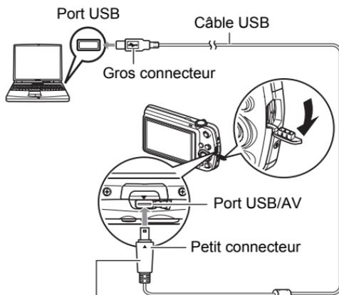
Tout en veillant à bien aligner le repère ▼ sur l'appareil photo et le repère ▲ sur le connecteur du câble USB, branchez le câble sur l'appareil photo.
