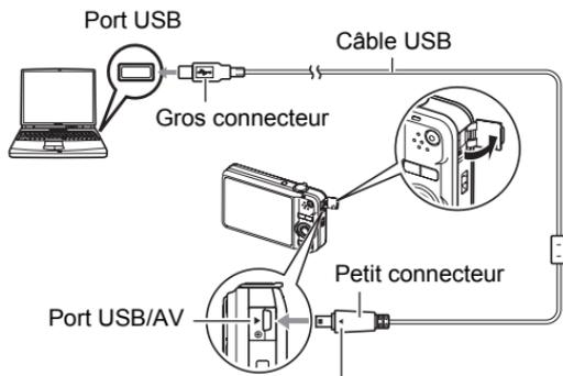
Tout en veillant à bien aligner le repère ► sur l'appareil photo et le repère ◀ sur le connecteur du câble USB, branchez le câble sur l'appareil photo.
