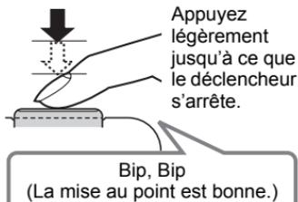
Appuyez légèrement jusqu'à ce que le déclencheur s'arrête.
