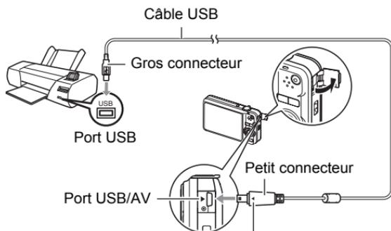
Tout en veillant à bien aligner le repère ▶ sur l'appareil photo et le repère ◀ sur le connecteur du câble USB, branchez le câble sur l'appareil photo.
