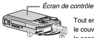
Tout en appuyant doucement sur le couvercle, faites-le glisser dans le sens de la flèche pour l'ouvrir.
