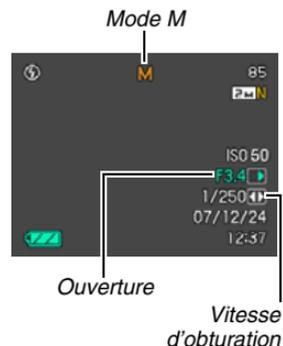
3. Appuyez sur [SET] le nombre de fois nécessaire pour sélectionner le réglage d'ouverture, puis utilisez [◀] et [▶] pour spécifier l'ouverture.
