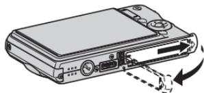
Tout en appuyant doucement sur le couvercle, faites-le glisser dans le sens de la flèche pour l'ouvrir.
