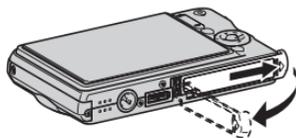
Tout en appuyant doucement sur le couvercle, faites-le glisser dans le sens de la flèche pour l'ouvrir.
