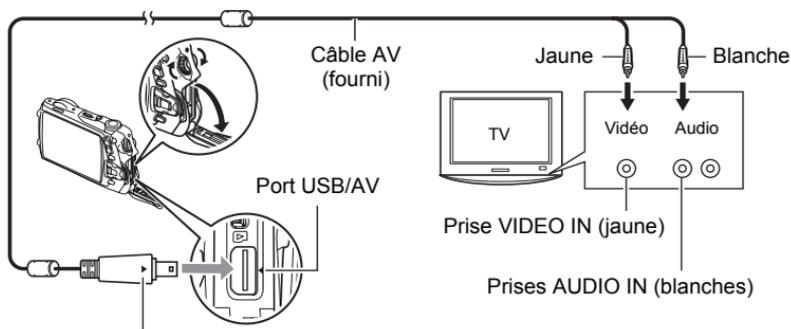
Tout en veillant à bien aligner le repère ◀ sur l'appareil photo et le repère ▶ sur le connecteur du câble AV, branchez le câble sur l'appareil photo.
