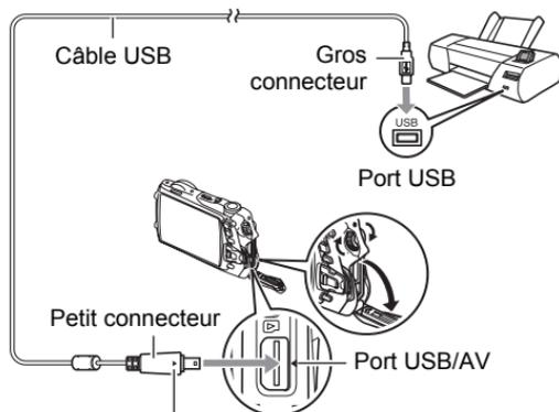
Tout en veillant à bien aligner le repère ◀ sur l'appareil photo et le repère ▶ sur le connecteur du câble USB, branchez le câble sur l'appareil photo.
