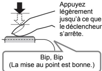
Appuyez légèrement jusqu'à ce que le déclencheur s'arrête.
