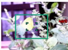
L'appareil photo sauvegarde automatiquement les photos lorsqu'il constate que le sujet est sorti du cadre.
