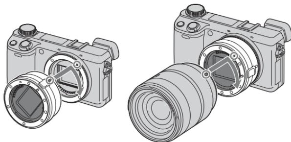
Les fonctions disponibles varient selon le type d'adaptateur pour monture d'objectif utilisé.
