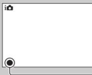
Lorsque l'appareil photo ne parvient pas à faire automatiquement la mise au point sur le sujet, le témoin de mise au point clignote. Recadrez l'image, ou changez le réglage de mise au point.
