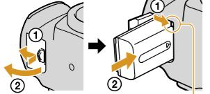
Introduisez fermement la batterie à fond tout en appuyant sur le levier de verrouillage avec l'extrémité de la batterie.
