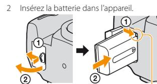
Introduisez fermement la batterie à fond tout en appuyant sur le levier de verrouillage avec l'extrémité de la batterie.
