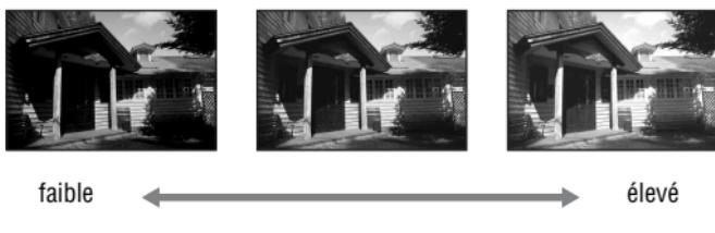
Lorsque vous utilisez une vitesse d'obturation plus élevée, l'appareil ouvre l'obturateur pendant une durée plus courte. Cela signifie que moins de lumière pénètre dans l'appareil, ce qui provoque une image plus sombre. Pour prendre des clichés plus lumineux, vous pouvez ouvrir l'ouverture (le trou par lequel la lumière passe) d'un certain montant, de manière à ajuster le niveau de lumière qui pénètre dans l'appareil en une seule fois.
