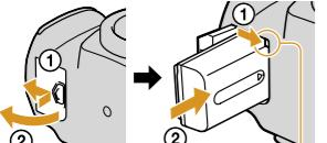
Inserire saldamente fino in fondo la batteria premendo contemporaneamente la leva di blocco con la punta della batteria.
