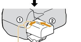
Introduisez fermement la batterie à fond tout en appuyant sur le levier de verrouillage avec l'extrémité de la batterie.
