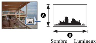
Un histogramme est un graphique permettant de visualiser la luminosité d'une image. Appuyez plusieurs fois sur ▲ (DISP) sur la touche de commande pour afficher l'histogramme à l'écran. L'histogramme signale une image claire lorsqu'il est décalé vers la droite, une image sombre lorsqu'il est décalé vers la gauche.
