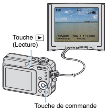
Les images prises avec l'appareil apparaissent sur l'écran du téléviseur.
