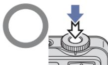
Indicateur de verrouillage AE/AF Clignotement → allumé/bip
