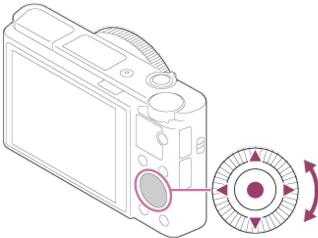
Vous pouvez sélectionner les éléments de réglage en tournant la molette de commande, ou en appuyant sur son côté supérieur/inférieur/droit/gauche. Validez votre sélection en appuyant sur ● au centre de la molette de commande.
