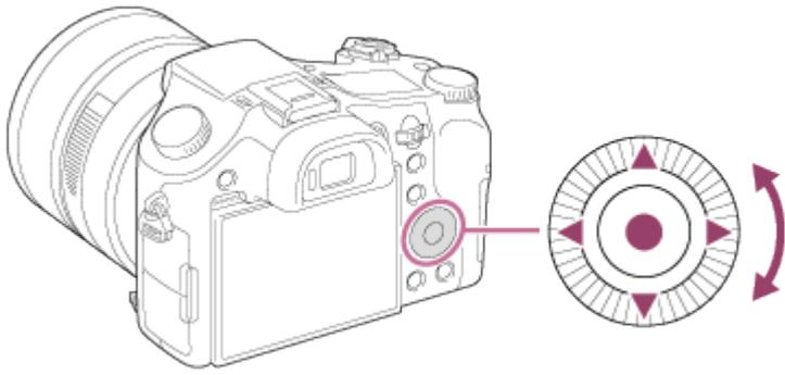
Vous pouvez sélectionner les éléments de réglage en tournant la molette de commande, ou en appuyant sur son côté supérieur/inferieur/droit/gauche. Validez votre sélection en appuyant sur ● au centre de la molette de commande.
