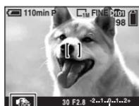
Indicateur de verrouillage de mise au point manuelle
