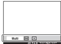
Maintenez enfoncé (mode de mesure) et tournez la molette de commande principale pour sélectionner le réglage désiré.
