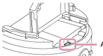
4. Maintenez la touche Wi-Fi enfoncée pendant 2 secondes minimum. L'enregistrement est terminé quand l'appareil photo émet le bip d'exécution de la connexion. Quand la connexion est établie, une image apparaît sur la télécommande Live-View.
