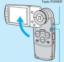
1 Accendere la fotocamera aprendo il pannello LCD in direzione della freccia. Ruotare lo il display LCD per regolare l'angolazione desiderata.
