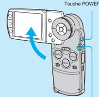
1 Allumez l'appareil photo en ouvrant le panneau LCD dans le sens de la flèche. Faites tourner l'écran LCD pour régler l'angle souhaité.
