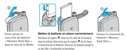
Faites glisser le couvercle de batterie/Memory Stick Duo dans le sens de la flèche.
