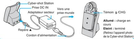
Le temps de charge est d'environ 150 minutes pour une batterie complètement déchargée à une température de 25 °C (77 °F). Il peut être plus long dans certaines circonstances ou conditions.
