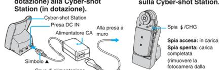
Il tempo di carica di un blocco batteria completamente scarico ad una temperatura di 25 °C è pari a circa 150 minuti. La carica potrebbe richiedere più tempo in certe circostanze o condizioni.
