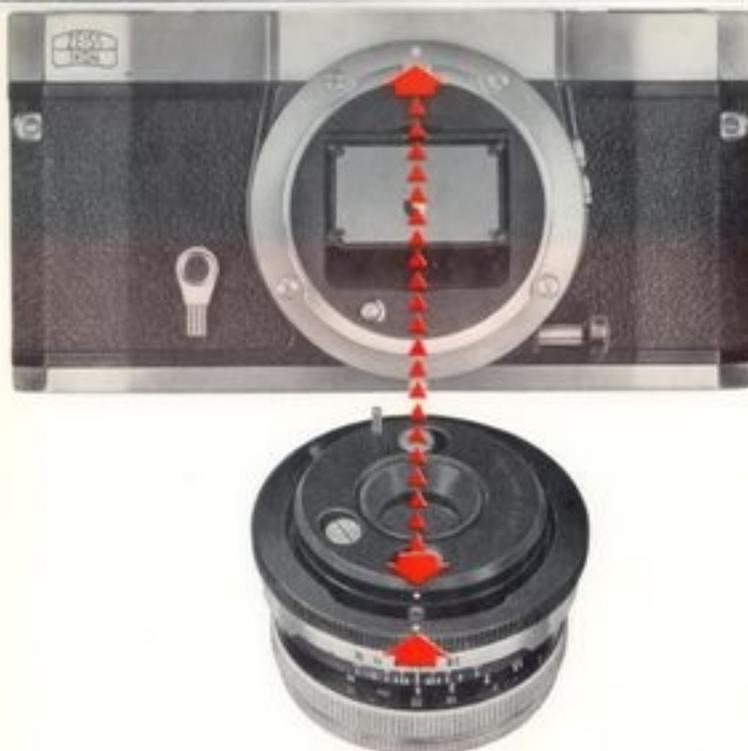
**Pour mettre l'objectif en place:** Amener d'abord le point jaune à l'intérieur de la bague moletée 2 au-dessus du point jaune de l'objectif (la bague se bloque dans cette position). Mettre ensuite l'objectif en place en veillant à ce que les points jaunes de l'objectif et du boîtier coïncident parfaitement. Lorsque l'objectif est engagé à fond dans le boîtier, le fixer en faisant tourner la bague moletée 2 dans le sens des aiguilles d'une montre.
