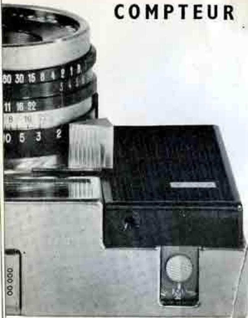
Appuyer sur le bouton strié 1. Le faire tourner dans le sens inverse des aiguilles d'une montre, pour amener le compteur sur le repère orange placé entre les graduations 36 et 0 (pour un film de 36 poses) ou sur la graduation 22 (pour un film de 20 poses).
