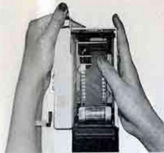
Engager, en manœuvrant le levier d'armement jusqu'à la butée, les perforations du film sur les dents du tambour d'entraînement. Ensuite, tout en maintenant le chargeur en position normale, agir sur la manivelle de rebobinage pour obtenir une légère tension du film. Refermer alors le dos et replier la manivelle de rebobinage dans son logement.
