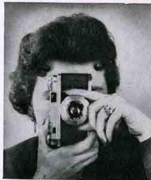
**PARALLAXE.** — L'axe du viseur-télémetre ne coïncidant pas exactement avec celui de l'objectif, il y a lieu, pour les prises de vues de sujets aux distances inférieures à 2 mètres, de rétablir l'exactitude du cadrage en déplaçant légèrement l'appareil, que la vue soit prise en hauteur ou en largeur, de façon à amener l'objectif bien en face du sujet.
