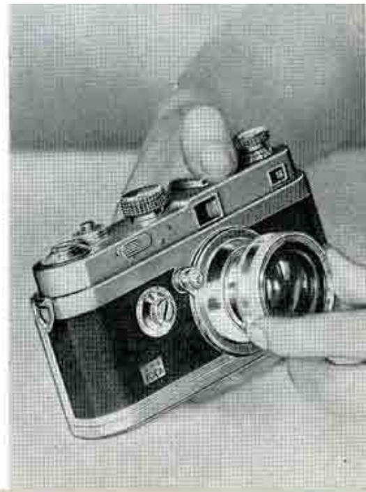
L'objectif (14) est amovible sur la monture à mise au point hélicoïdale (15) : il suffit de le dévisser de droite à gauche pour le retirer.
