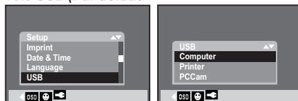
Vous pouvez sélectionner un périphérique externe pour connecter l'appareil photo en utilisant le câble USB.
