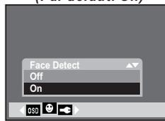
La détection des visages vous permet de faire la mise au point sur les visages humains. La détection des visages ne fonctionne que pour les photos.
