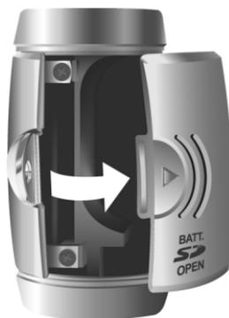
3. Insérez la carte mémoire avec le coin avec fente face au bord externe de l'appareil (la circuiterie dorée étant tournée vers l'arrière de l'appareil).
