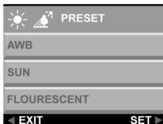
Modifiez le pré réglage de la balance des blancs en fonction des conditions d'éclairage dans lesquelles la photo est prise.
