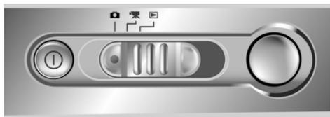
Pour la prise de photos basique "viser et appuyer", utilisez le mode Capture indiqué par l'icône d'appareil
