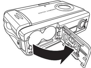
3. Insérez les batteries dans le compartiment en respectant la polarité.
