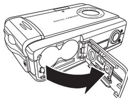
3. Insérez une carte SD dans le slot, face étiquette dirigée vers l'avant de l'appareil jusqu'à ce qu'elle se encliquette à sa place.
