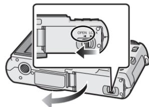
**2** Batterie: Introduisez-la complètement en faisant attention au sens d'insertion. Tirez le levier (A) en direction de la flèche pour retirer la batterie.
