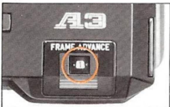
7. Quand le compteur de vue affiche "1", vous êtes prêt à photographier. La fenêtre située sur le dos du boîtier vous permet de vérifier si l'appareil est chargé ou non.
