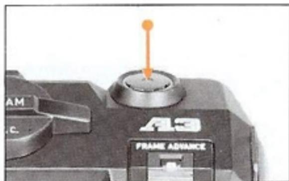
5. Fermer le dos en vous assurant qu'il s'engage bien à sa place. Dès que vous aurez actionné le déclencheur, l'appareil avancera le film en continu jusqu'à la vue n° 1. Pendant l'opération la lampe témoin d'avancement est allumée (quelle que soit la position du sélecteur de mode, l'obturation s'effectuera au 1/1000s jusqu'à ce que le compteur arrive sur la vue n° 1).
