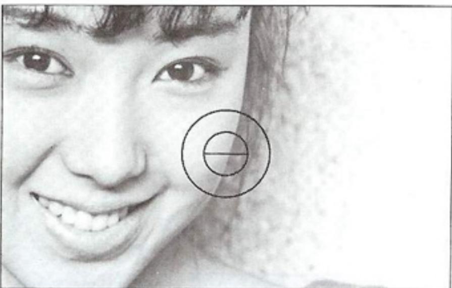
Vous pouvez faire la mise au point de trois manières différentes : à l'aide du stigmomètre des microprismes ou du fond dépoli mat. Pour utiliser le stigmomètre, faites tourner la bague de distance jusqu'à l'alignement des deux sections d'images dans la partie centrale du viseur. Pour utiliser la couronne de microprismes, faites de même jusqu'à ce que ceux-ci ne soient plus visibles. Avec le fond dépoli, cherchez la netteté la plus grande.
