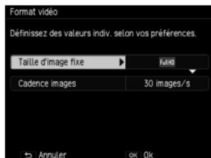
Les réglages suivants peuvent être effectués. Les cadences d'image sélectionnables dépendent de la taille d'image fixe.
