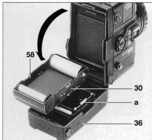
Il n'est pas conseillé de précharger les porte-bobines par des températures se situant au-dessous de 0°, mais de ne sortir le film de son emballage que pour le charger directement dans le boîtier et de l'avancer sur vue « 1 ». Le froid durcit en effet la partie collante de l'amorce du film, ce qui peut occasionner des défauts d'entraînement.
