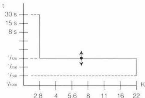
L'unité de commande «MasterControl» (fournie en accessoire) permet de définir et de modifier soi-même (entre 15 et  $\frac{1}{500}$  s) la vitesse de base du programme automatique et de l'adapter ainsi aux tâches photographiques spécifiques. Il en résulte ainsi un choix de 14 programmes automatiques.
