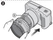
2 Tournez la bague © en direction de la flèche jusqu'à ce que [LOCK] soit ajusté à A de l'adaptateur.
