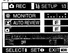
Si l'appareil photo n'est pas utilisé pendant 15 secondes, l'affichage du moniteur LCD s'éteint et la consommation d'énergie est économisée.
