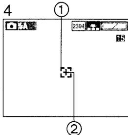
Lorsque ce mode est sélectionné, la mise au point et l'exposition seront ajustées pour viser une zone limitée. Ceci convient lorsque vous photographiez en condition de faible éclairage et lorsque vous désirez photographier une zone précise.
