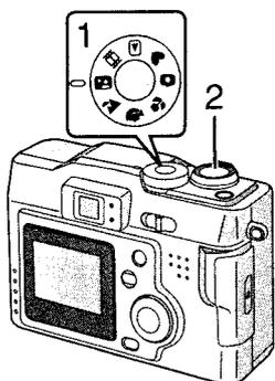
Le Mode Portrait Nocturne combine le flash électronique avec un mode "d'obturation lent". Cette caractéristique unique vous permet de photographier des sujets proches contre un arrière-plan nocturne naturel. Puisque la vitesse d'obturation est lente, nous vous conseillons vivement l'utilisation d'un trépied pour stabiliser l'appareil photo.
