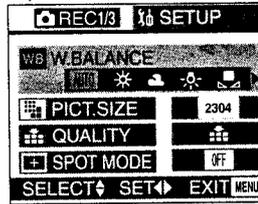
La balance des blancs automatique est conçue pour faire en sorte que l'appareil photo produise automatiquement des tons naturels. Cela fonctionne dans la majorité des cas. Dans certaines situations, en présence de différents types d'éclairage, on peut accroître les performances en réglant la balance des blancs manuellement.
