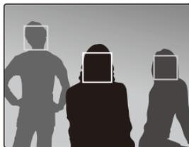
En mode Prise de vue, sélectionnez ▲ → [OFF] → [ON]. Le visage le plus près apparaît dans un cadre blanc de mise au point et les autres apparaissent dans des cadres gris.
