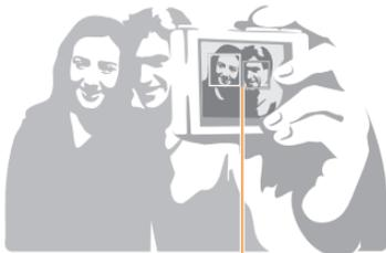
Quand des visages sont détectés au centre de l'image, l'appareil photo émet des bips rapides.
