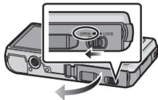
**2** Batterie: Tout en étant attentif au sens de la batterie, introduisez-la jusqu'à entendre le son de verrouillage puis vérifiez qu'elle est bloquée par le levier (A). Tirez le levier (A) dans le sens de la flèche pour retirer la batterie.
