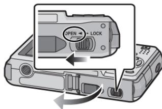
**2** Batterie: Introduisez la batterie jusqu'à ce qu'elle soit verrouillée par le levier (A) en faisant attention au sens dans lequel vous l'introduisez. Tirez le levier (A) dans le sens de la flèche pour retirer la batterie.
