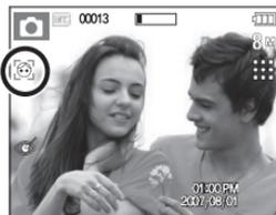
3. Appuyer sur la touche de **Déclencheur**. Le cadre de la mise au point devient vert quand la mise au point est activée.
