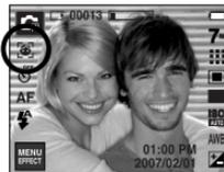
2. La taille et la position du cadre de la mise au point sont réglées automatiquement au niveau du visage du sujet.
