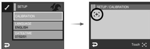
※ Quand vous calibrez l'écran LCD, appuyez exactement sur le point de calibrage ou sinon les menus ne seront pas sélectionnés ou réglés.
