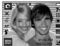
3. Enfoncez le déclencheur à mi-course. La cadre de la mise au point devient vert quand la mise au point est activée.
