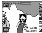
[Enfoncez le déclencheur à mi-course et effectuez la mise au point sur le sujet]
