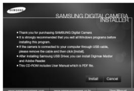
Vous devez d'abord installer le pilote de l'appareil photo avant de connecter celui-ci au PC.
