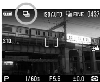
Le type de déclenchement peut être déterminé dans le menu de réglage rapide ou dans le menu [
