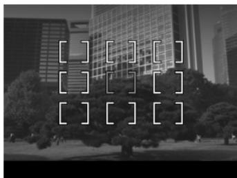
Le DP2S dispose de 9 zones de mise au point. Il est possible de sélectionner la zone souhaitée.
