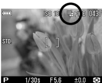
La taille de l'image peut être choisie dans le menu de réglage rapide (P.34) or [Paramètres prise de vue] (P.26) → [Taille de l'image].
