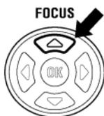
Lorsque l'autofocus est en mode normal (sans icône), la plage de mise au point va de 28cm à l'infini. Il est possible de passer en mode limité (▲ s'affiche) en appuyant sur la touche **FOCUS**. En mode limité, la plage de mise au point s'étend de 1m à l'infini et l'AF est plus rapide.
