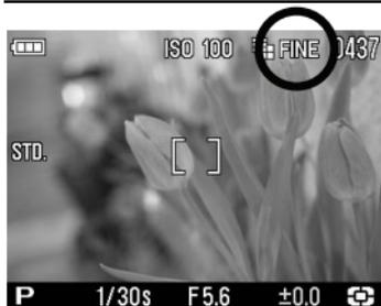
La qualité d'image peut être réglée dans le menu de réglage rapide (P.34), ou dans [ Paramètres prise de vue ] (P.26) → [Qualité d'image].
