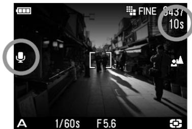
Appuyez sur le déclencheur. L'enregistrement débutera dès que l'image aura été transférée sur la carte mémoire. (Ceci dure quelques secondes). Durant l'enregistrement, l'icône **🎤** et le témoin d'acquisition clignotent, et le compteur de temps situé en haut à droite du moniteur couleur décompte le temps restant.
