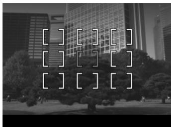
Le DP1 dispose de 9 zones de mise au point. Il est possible de sélectionner la zone souhaitée.
