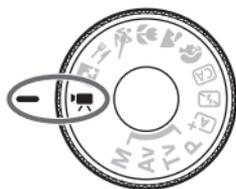
L'enregistrement vidéo est activé en plaçant la molette de mode sur
