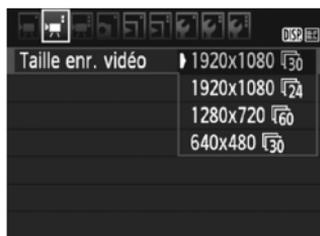
L'option de menu [P2 : Taille enr. vidéo] vous permet de sélectionner la taille d'image de la vidéo [\*\*\*\*x\*\*\*\*] et la cadence d'enregistrement [1/60] (images enregistrées par seconde). L'élément [1/60] (cadence d'enregistrement des images) change automatiquement selon le réglage [P2 : Système vidéo].
