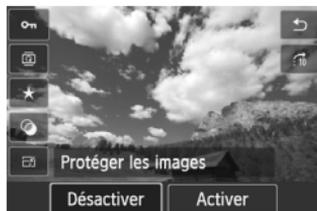
La marche à suivre est la même que celle pour utiliser l'écran de contrôle rapide dans le mode de prise de vue. Cependant, pour les filtres créatifs et le redimensionnement, vous devez également appuyer sur **<Q/SET>** pour les régler. Pour en savoir plus, voir page 260 pour les filtres créatifs et page 262 pour redimensionner.
