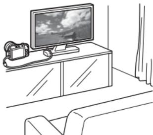
Utilisez le câble vidéo AVC-DC400ST ou un câble HDMI HTC-100 (tous deux vendus séparément) afin de raccorder l'appareil photo à un téléviseur. Vous pourrez ensuite lire les vidéos et photos capturées sur votre téléviseur.
