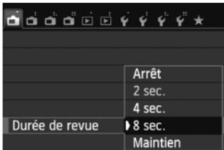
Dans l'onglet **[1]**, sélectionnez **[Durée de revue]**, puis appuyez sur **<Q/SET>**. Sélectionnez le réglage désiré, puis appuyez sur **<Q/SET>**.
