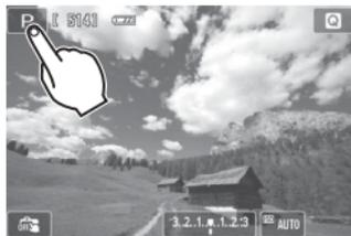
**1** Tapotez l'icône du mode de prise de vue dans le coin supérieur gauche de l'écran.
