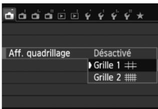
Dans l'onglet **[1]**, sélectionnez **[Aff. quadrillage]**, puis appuyez sur **<Q/SET>**. Sélectionnez **[Grille 1]** ou **[Grille 2]**, puis appuyez sur **<Q/SET>**.
