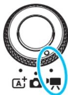
Placez la molette de sélection des modes sur
