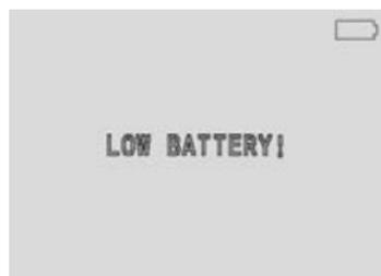
Quand la batterie est trop faible ou épuisée, un clignotant rouge signale "Batterie faible !"
