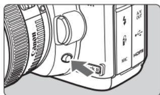
Appuyez sur la touche de contrôle de profondeur de champ pour ramener l'objectif à l'ouverture actuelle. Vous pouvez vérifier la profondeur de champ (plage de mise au point) dans le viseur.
