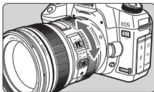
Pour effectuer un zoom, tournez manuellement la bague de zoom sur l'objectif. **Si vous souhaitez effectuer un zoom, faites-le avant la mise au point. Vous risquez de modifier légèrement la mise au point en tournant la bague de zoom après avoir effectué la mise au point.**
