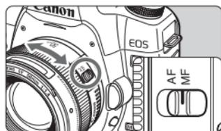
**1** Positionnez le sélecteur de mode de mise au point de l'objectif sur <MF>.
