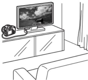
Utilisez le câble vidéo stéréo fourni ou un câble HDMI HTC-100 (vendu séparément) afin de raccorder l'appareil photo à un téléviseur. Vous pourrez ensuite visionner les vidéos et photos capturées sur votre téléviseur. Si vous possédez un téléviseur Haute définition et raccordez votre appareil photo au moyen d'un câble HDMI, vous pourrez voir vos vidéos Full-HD (Full High-Definition 1920x1080) avec une meilleure qualité d'image.
