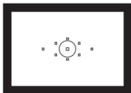
Le viseur comporte 9 collimateurs autofocus. La sélection d'un collimateur autofocus adéquat vous permet de prendre des photos avec mise au point automatique en cadrant le sujet à votre guise.
