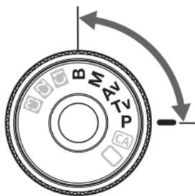
Dans les modes de prise de vue **P/Tv/Av/M/B**, vous pouvez sélectionner la vitesse d'obturation, l'ouverture et d'autres réglages de l'appareil photo afin de modifier l'exposition et obtenir différents effets.
