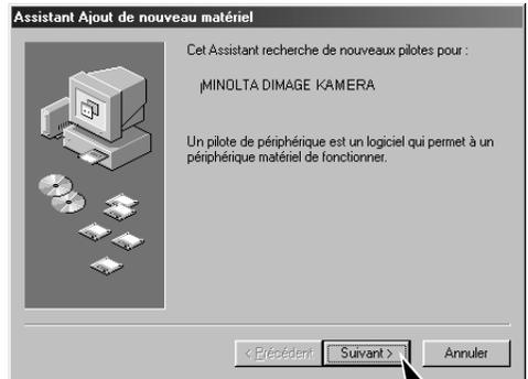
Sélectionnez la recherche du pilote recommandé. Cliquez sur “Suivant”.
