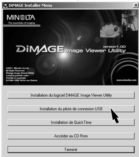
Avant de connecter l'appareil photo à l'ordinateur, placez le CD-Rom DiIMAGE dans le lecteur de CD. Le menu d'installation DiIMAGE doit être automatiquement activé. Pour installer automatiquement le pilote USB Windows 98, cliquez sur le bouton de démarrage d'installation du pilote de périphérique USB. Une fenêtre s'affiche pour confirmer l'installation du pilote ; cliquez sur "Oui" pour poursuivre l'installation.
