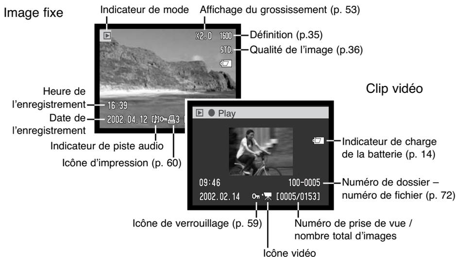
Un enregistrement audio (p. 34) ne possède aucune donnée d'image. Par conséquent, pour indiquer un fichier audio, l'écran LCD devient bleu. La date et l'heure de l'enregistrement, l'état de verrouillage, le numéro de la prise de vue et les numéros de dossier et de fichier s'affichent.
