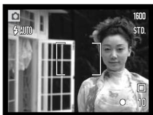
Sans relâcher le déclencheur, repositionnez le sujet dans la zone d'image. Appuyez complètement sur le déclencheur pour effectuer la prise de vue.
