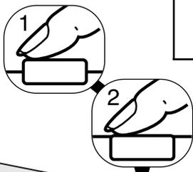
Appuyez sur le déclencheur à mi-course (1) pour verrouiller la mise au point et l'exposition.
