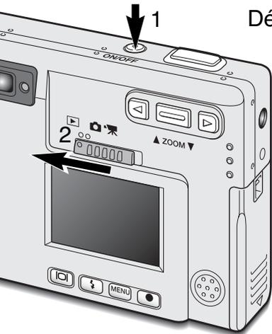
La définition de la langue du menu s'effectue dans la section Config 2 du menu Lecture. Mettez l'appareil photo sous tension en appuyant sur l'interrupteur principal situé à côté du déclencheur. Faites glisser le sélecteur de modes en position Lecture (2).
