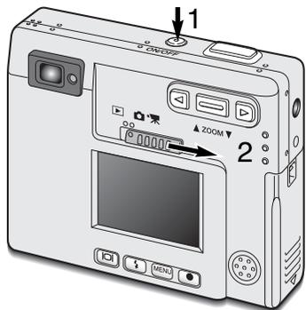
Mettez l'appareil sous tension en appuyant sur l'interrupteur principal (1).
