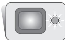
Si la charge est insuffisante pour faire fonctionner l'appareil, le témoin indicateur situé à côté du viseur devient rouge et clignote durant trois secondes. Le déclencheur ne fonctionne plus. La batterie doit être rechargée.
