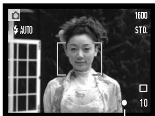
Placez le sujet dans la zone de mise au point de l'écran LCD ou centrez-le dans le viseur. Appuyez sur le déclencheur à mi-course et maintenez-le pour verrouiller la mise au point.
