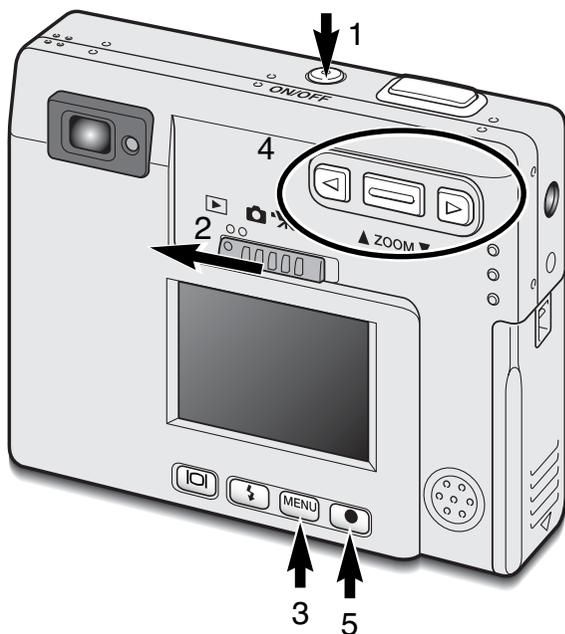
Mettez l'appareil sous tension en appuyant sur l'interrupteur principal situé à côté du déclencheur (1).
