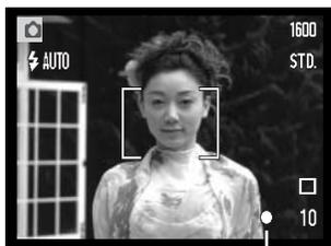
Placez le sujet dans la zone de mise au point de l'écran LCD ou centrez-le dans le viseur.
