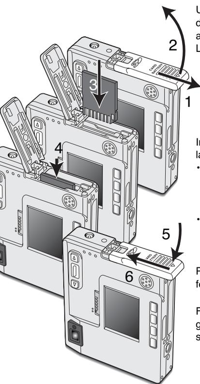
Une carte mémoire SD (Secure Digital) ou une carte multimedia doit être insérée pour permettre à l'appareil de fonctionner. Si aucune carte n'est insérée, un avertissement s'affiche sur l'écran LCD ; le déclencheur peut néanmoins être actionné.
