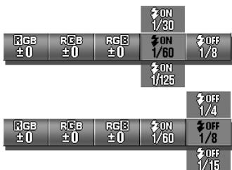
Pour spécifier la vitesse limite d'obturation au flash (automatique ou forcé). L'appareil fixe une vitesse égale ou supérieure à cette limite.
