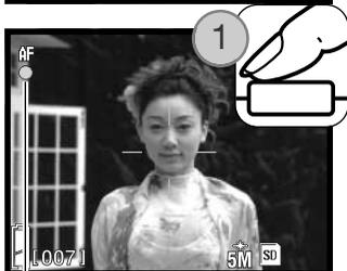
Appuyer à mi-course sur le déclencheur (1) pour mémoriser la mise au point et l'exposition.
